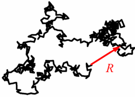
図5. ランダムコイルの両末端間ベクトル
